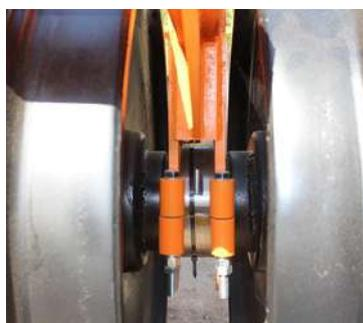
Рама соединена с рабочей частью с помощью четырех скоб с подшипниками скольжения
