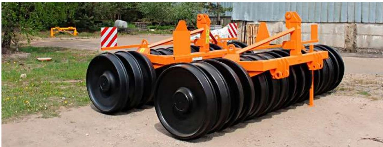
Рабочая часть не разборная. Состоит из оси на которую приварены рабочие колеса. Число рабочих колес зависит от рабочей ширины трамбовщика.
